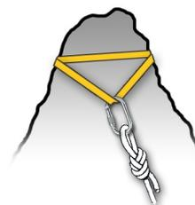
Achtung: Seile niemals direkt in Bandschlingenmaterial oder Reepschnüre knüpfen! Durch die entstehende Reibungswärme schmelzen diese Textilien binnen Sekunden durch!
