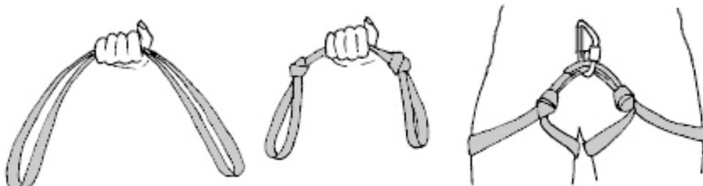
Bei Verwendung derartig improvisierter Sitzgurte ist zusätzlich das Tragen eines Brustgurtes (im Notfall auch nur eines behelfsmäßigen) empfehlenswert, da man sehr leicht nach hinten kippen kann.
