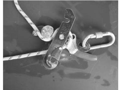
Abseilgerät *Petzl Stop* geöffnet mit eingelegtem Seil.
