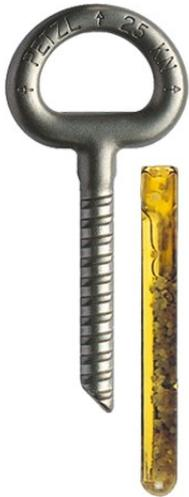
Verbundanker werden, wie der Name schon vermuten lässt, im Bohrloch eingeklebt. Sie weisen nicht nur sehr hohe Haltekräfte (meistens > 20 kN) auf, sondern sind auch sehr unempfindlich gegen Korrosion, da der Klebstoff das Bohrloch versiegelt. Daher werden sie gerne für Langzeiteinbauten verwendet. Verbundanker finden auch verbreitet Anwendung im Bergsport.
