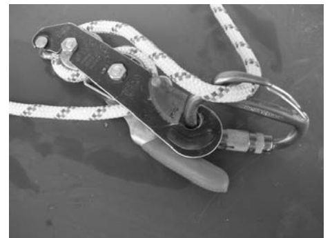
Die Umlenkung des Seils durch einen speziellen Bremskarabiner erzeugt zusätzliche Reibung.
