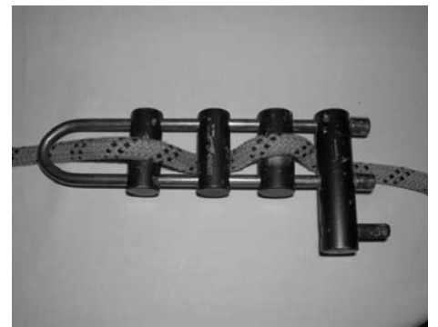
Abseilgerät Kong-Rack mit eingelegtem Seil.
