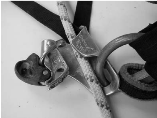
Bruststeigklemme (Croll) geöffnet, oben ist ein als Brustgurt dienendes Band erkennbar.
