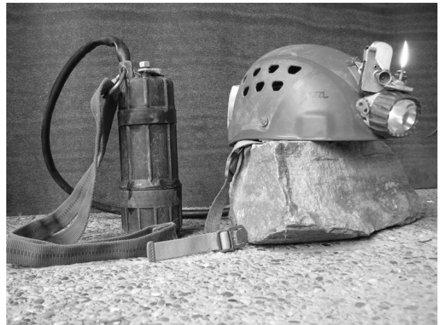
Sehr gebräuchliches System bestehend aus fest montierter Helmlampe (Halogenlampe oder LED wahlweise schaltbar) sowie Karbidlampe mit Entwickler aus Kunststoff.
