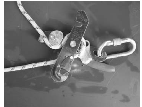
Abseilgerät Petzl Stop geöffnet mit eingelegtem Seil.
