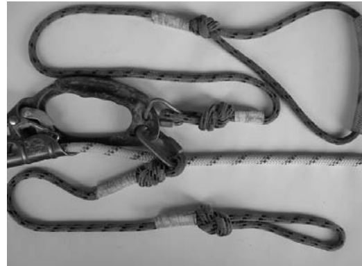
Handsteigklemme mit Sicherungsschlinge (wird im Zentralschraubglied eingebunden) und Steigschlinge
