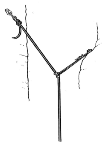
Abb. 5: Ypsilon-Befestigung an einer normalen Lasche und einer AS
